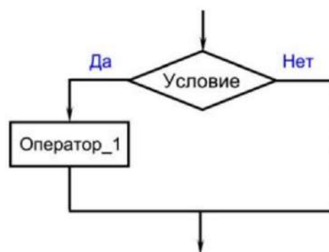
Рис. 5. Фрагмент блок-схемы разветвляющегося алгоритма (неполная форма записи)
