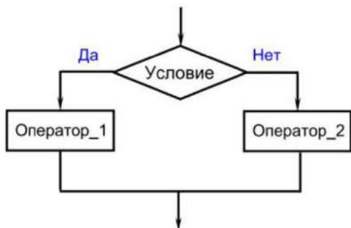
Рис. 4. Фрагмент блок-схемы разветвляющегося алгоритма (полная форма записи)
