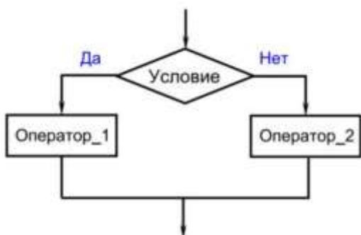
Рис. 1.1. Фрагмент блок-схемы разветвляющегося алгоритма (полная форма записи)
