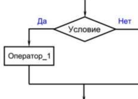
Рис. 1.2. Фрагмент блок-схемы разветвляющегося алгоритма (неполная форма записи)
